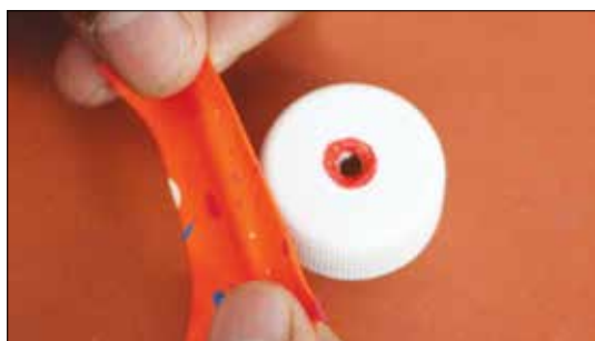
▲ شکل ۸: قرار دادن تکه‌ای از بادکنک روی سوراخ
