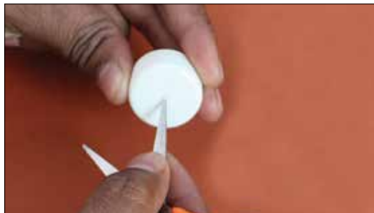
▲ شکل ۷: ایجاد سوراخ روی درب بطری
